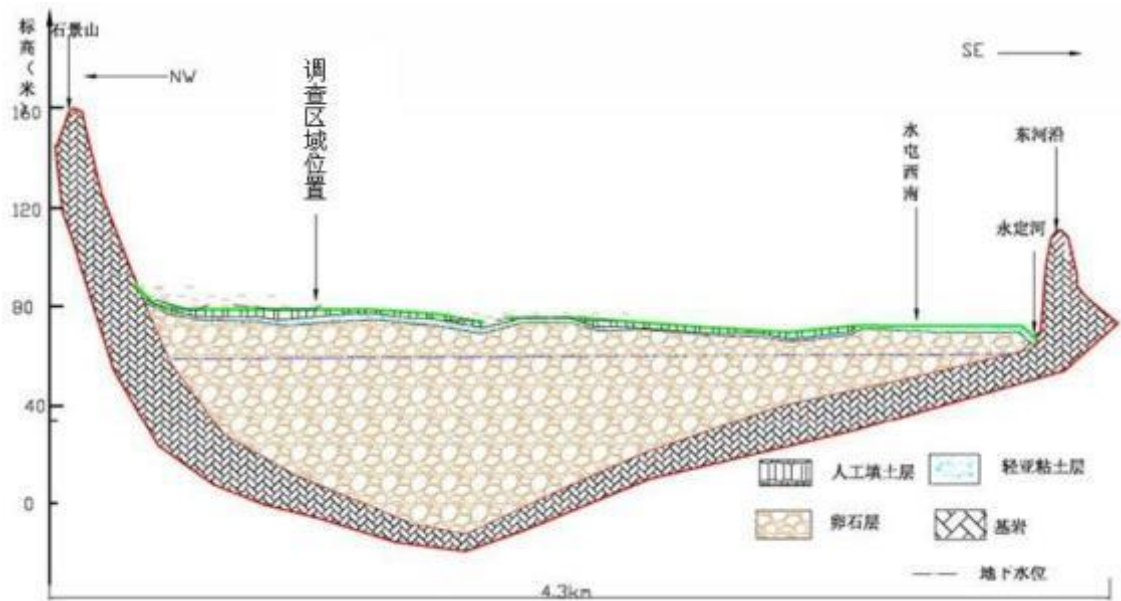
图 3.1- 4 地块所在区域地层岩性的垂直分布图
