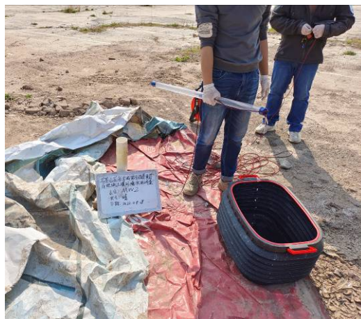
MW2 地下水洗采样前洗井
