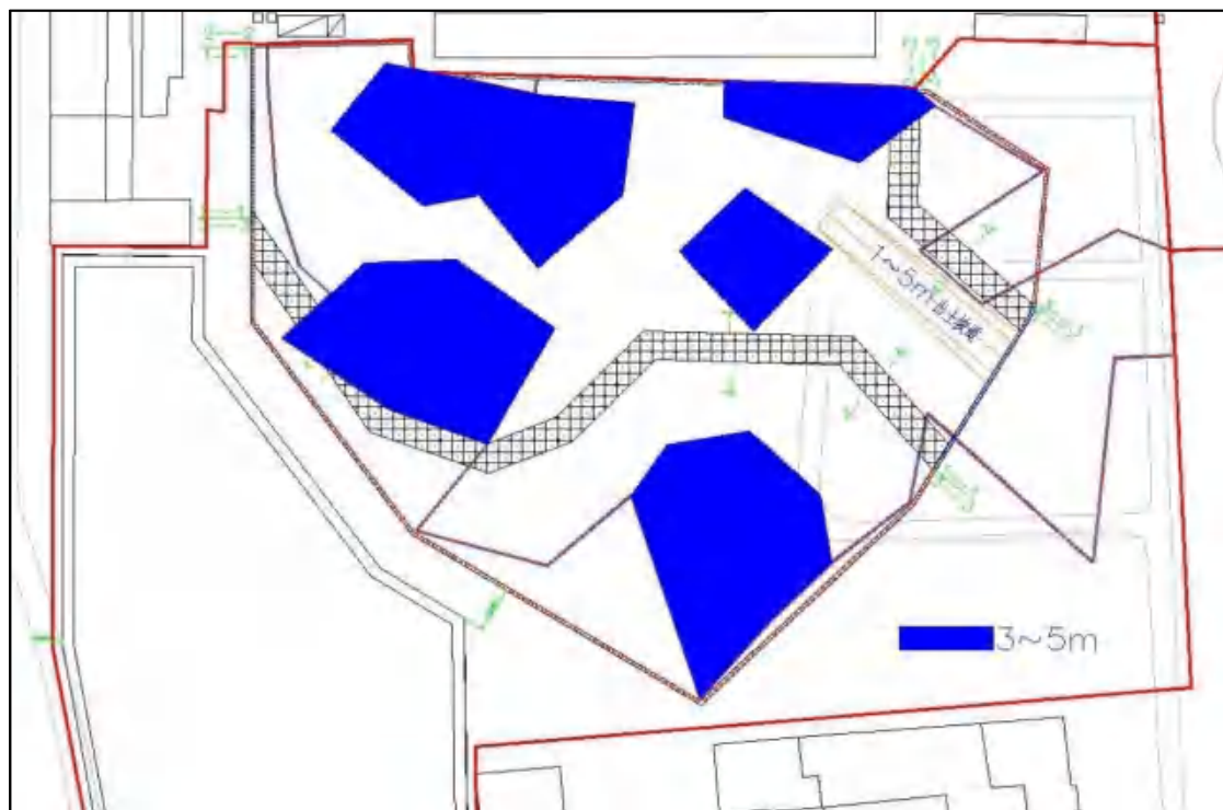
图 2.3-9 3~5m 开挖示意图
