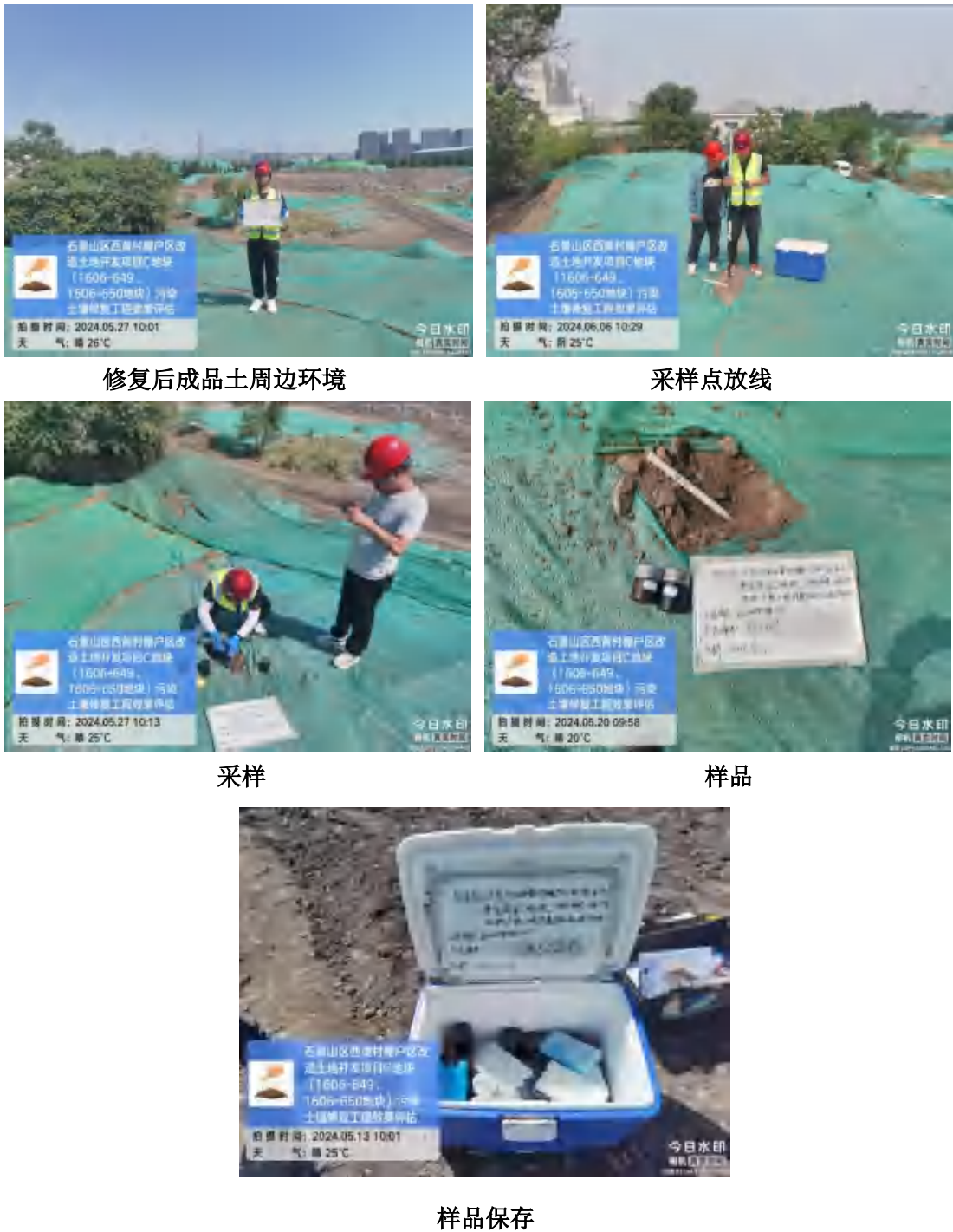
图 7.1-4 修复后成品土采样情况
