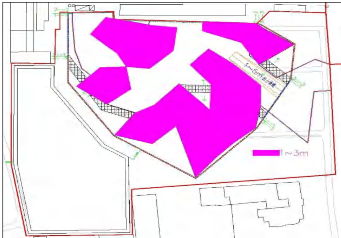
图 2.3-8 1~3m 开挖示意图
