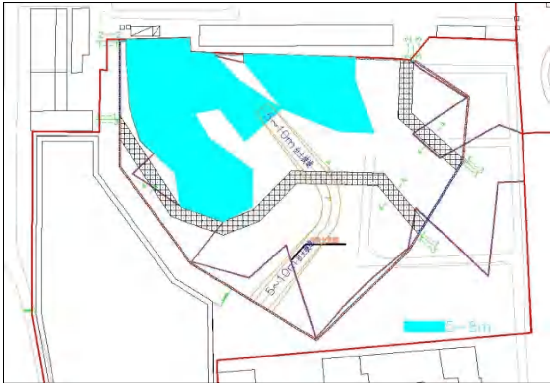
图 2.3-10 5~8m 开挖示意图
