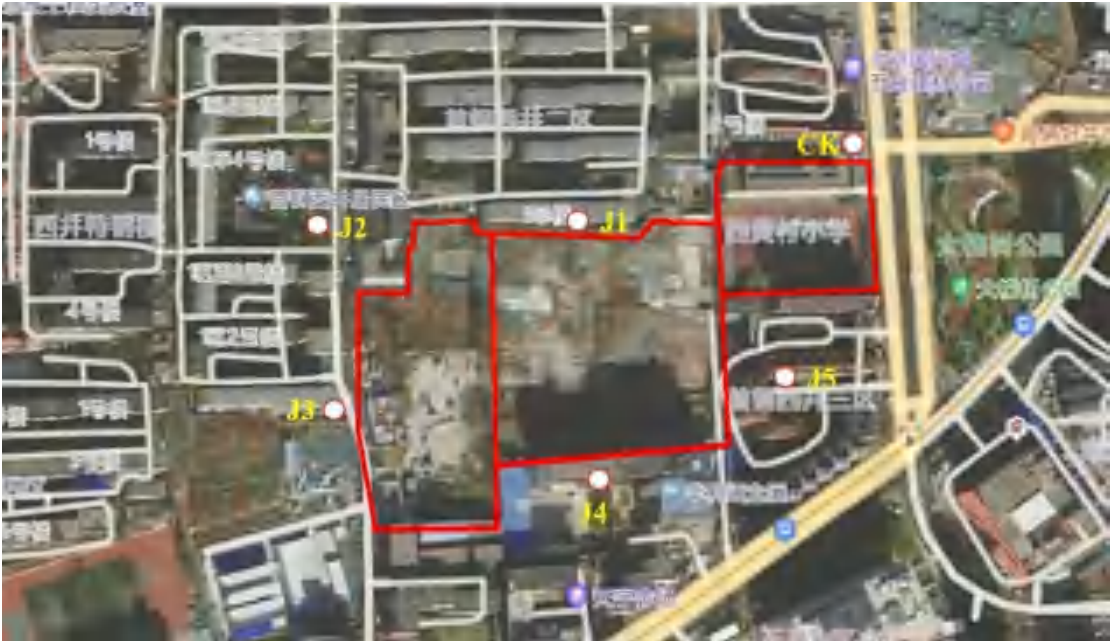
图 4.6-2 清挖现场大气无组织排放监测点位示例
