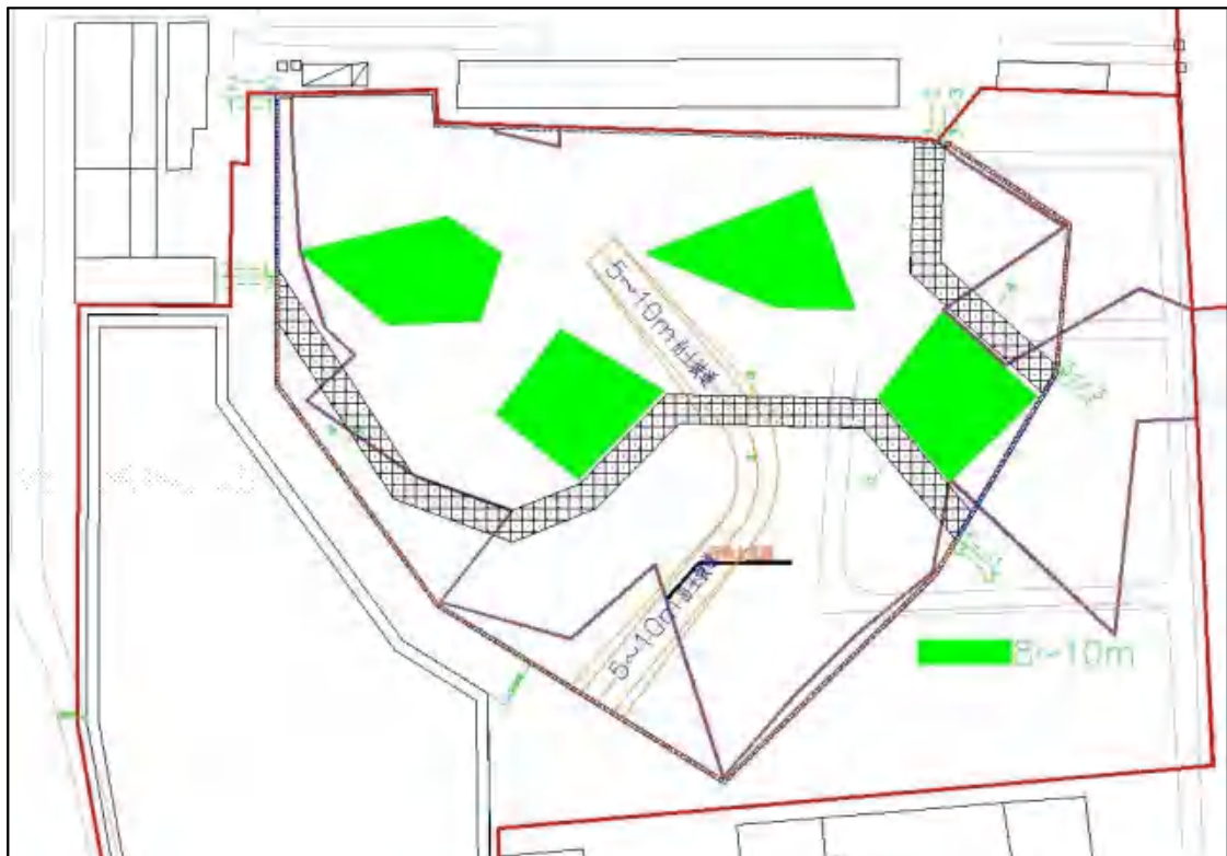
图 2.3-11 8~10m 开挖示意图
